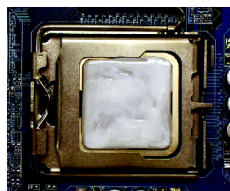
図 1 取り付けられたCPU表面にヒートシンクペーストを均一に塗ります。
